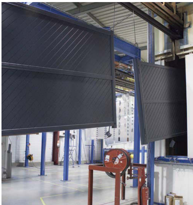
Thermolaquage après assemblage du portail
